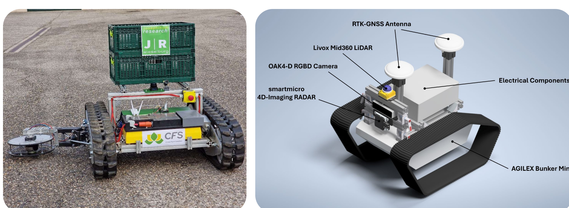
Abbildung 1: Darstellung der verwendeten Robotersysteme. Links: Weinbauroboter Dionysos. Rechts: erweiterte Sensorplattform.
